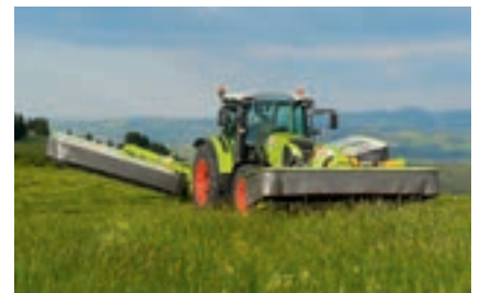
La suspension compacte du relevage avant confère à la faucheuse une garde au sol élevée en fourrière.
