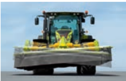
Adaptation au sol transversalement au sens d'avancement grâce à l'attelage oscillant librement.
